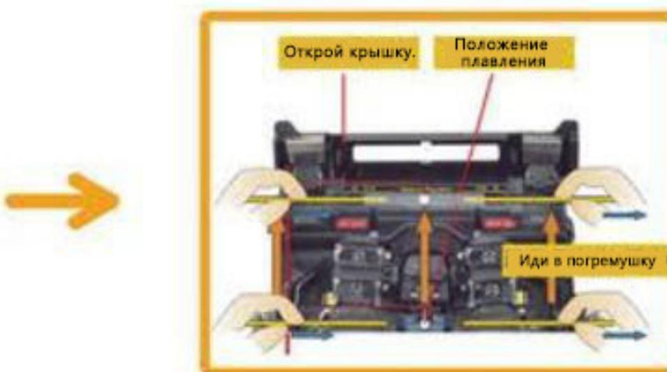
Примечание: при возникновении больших потерь в плавках или больших изменениях в высоте окружающей среды необходимо выполнить [стабильные электроды] и [коррекция электродов] до того, как их заклеймируют.
